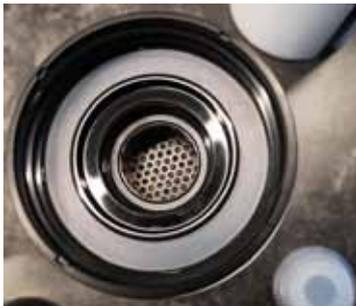
3. Die (-) Elektrode (Kathode) ist nun sichtbar. Bewahren Sie den Silikonstöpsel auf für Transport oder Lagerung. Die Kathode sollte durch Benetzen mit Wasser immer feucht bleiben.
