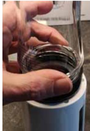
3. Schrauben Sie das Glasgefäß in den Adapter. Standardmäßig ist dort der Adapter 1 für Weithalsflaschen.
