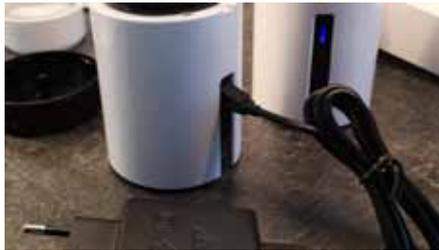
7. Heben Sie die Gummilasche an der Rückseite und schließen sie den Micro-USB-Stecker an
