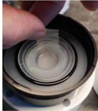
2. Entfernen Sie den Silikonstöpsel, der dem Schutz vor Austrocknung der Membran dient.
