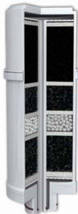
Bevor Wasser aus der Leitung oder dem Wasserhahn in die Wasserzelle der Aquion Wasserlonisier gelangt, wird es aufwändig gefiltert. Es handelt sich um einen Spezialfilter mit Filtervliesen, Carbonsgranulat, mineralischem Calcium (Calciumsulfid) und einem Aktivkohleblock (Porengröße ~ 0,5 µm) im oberen Filterbereich.
