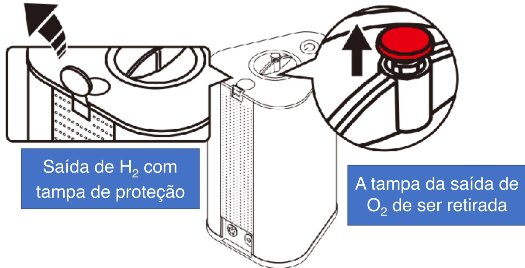
3. Abra a tampa encima da saída de H<sub>2</sub>. A seguir abra a válvula do O<sub>2</sub> ao puxá-la levemente.
