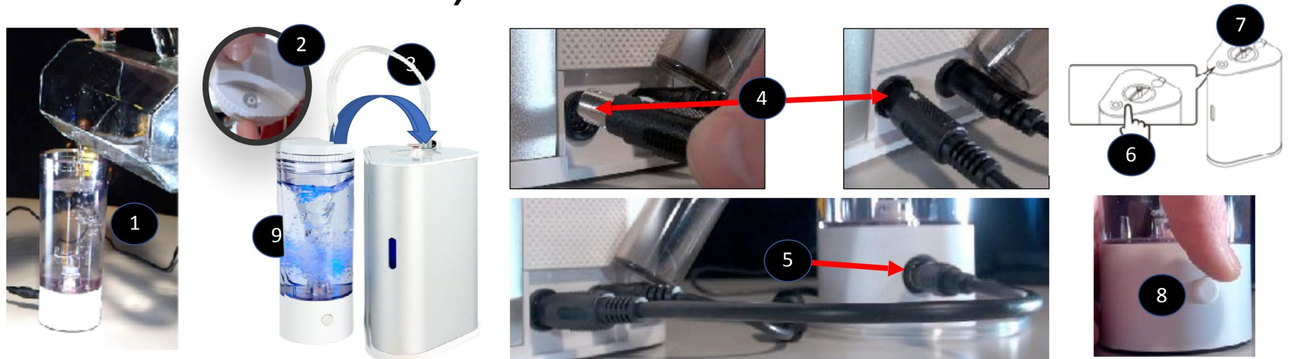
A água ou alguma outra bebida sem gás de sua preferência (chá, suco, leite etc.) é enchida exatamente até a marca de 400 ml mark (1) na garrafa de vórtice. A tampa do turbilhonador é virada para a posição indicada (2). O turbilhonador é então conectado ao gerador de hidrogênio utilizando a mangueira curta (3) dos acessórios do turbilhonador. **A saída do oxigênio deve estar sempre aberta!**
