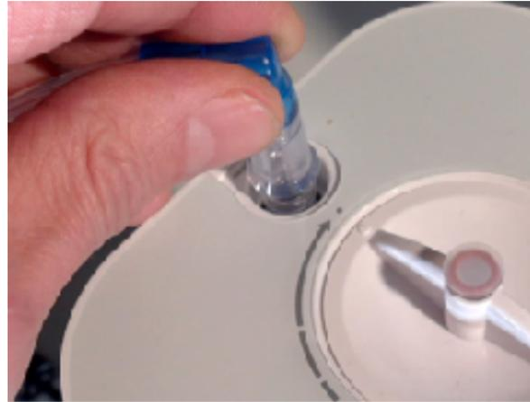
2. Empurre firmemente o final do inalador nasal na segunda saída do coletor de água.
